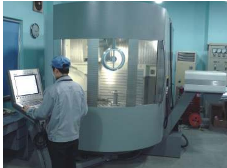
德国德马吉(DMG)五轴五联动加工中心 DMG 5-axis machining centre
